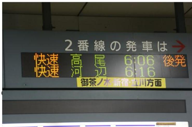
による回転幕等を使用して文字情報を表示し、列車接近や運行状況、発車時刻・番線を乗客に知らせるのが役目である。ICT化されたことにより、従来のサボ式・電球式に比べ管理コストの削減と明瞭性、乗客案内精度の大幅な向上を実現している。JR 東日本や大手私鉄各社で採用されているものには、最新の ICT 機器（特に中央指令室の列車運転管理システムとインターネット）と連携して情報を自動更新できるものもある。
