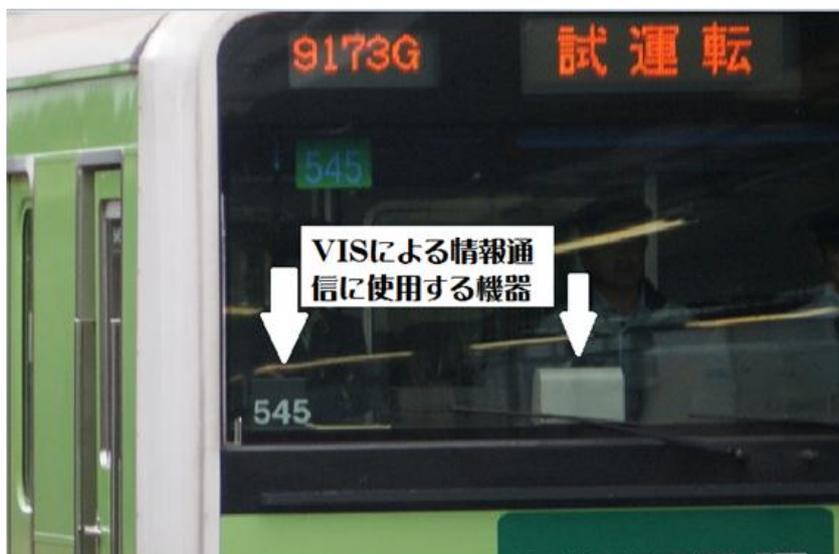
LCD を本格採用した E231 系 500 番台車両からは写真・動画を使用したデジタルサイネージ事業も開始されたが、一般的な運行情報だけでなく動画配信も VIS を介して行われており、山手線の場合、主要駅に設置されたミリ波無線型の情報伝送装置を使用し、即時性の求められるニュース配信や、最新の広告への書き換えが行われている<sup>17</sup>。
