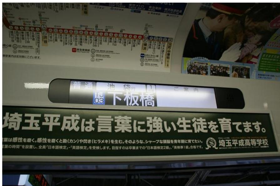
広告よりも狭いスペースであるのみ関わらず液晶画面を採用する事ができたため、明確性は従来の 3 色 LED タイプよりも抜群に良い。東武鉄道の他に京王電鉄でも採用が進んでおり、今後製造後 20 年程度の車両に対して設置が進んでいくものと思われる。
