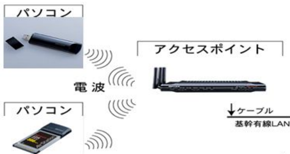
図 2 無線 LAN の仕組み（Infrastructure モード）
